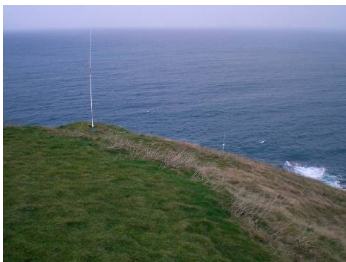
Figura 10: Fotografía de una de las 2 antenas (sistema CODAR) del sistema de HF radar del País Vasco.
